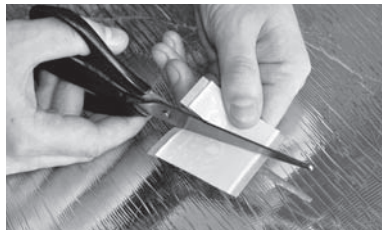
Рис. 7. Разрезание битумной изоляции на 2 части
