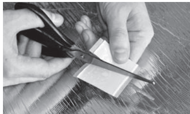
Рис. 7. Разрезание битумной изоляции на 2 части
