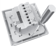
Рисунок 5. Демонтаж лицевой панели
